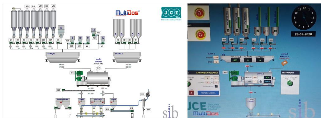
Obrázek 1: Výrobní proces malt a tvrdidel (PP2) (řádek 1 vlevo, řádek 2 vpravo).
